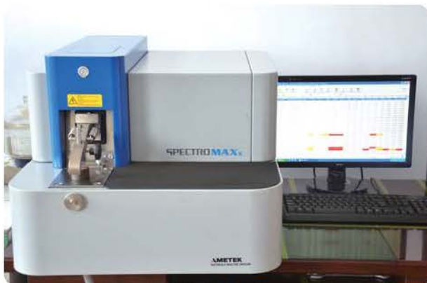
Определение содержания элементов в материале
